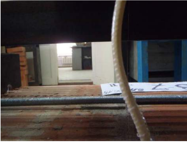
Фото 49. Положение анкера после сжатия под нагрузкой. Видим обрыв стекловолоконного шнура стержня.
