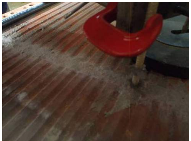
Фото 6. Критерием разрушения при вытягивании связи являются: разрыв связи, разрушение кладки, перемещение анкера более 5 мм или не прекращающиеся перемещения без увеличения нагрузки.
