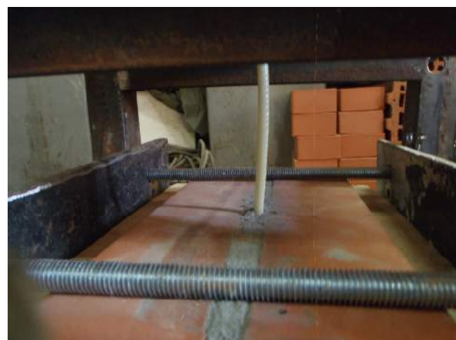
Фото 40. Положение анкера после сжатия в растворе шва.
