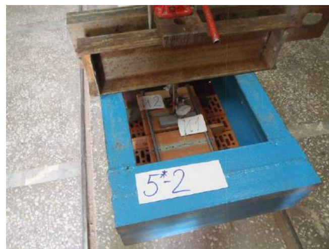
Фото 56. Испытание образца №2 серии 5* (дополнительные образцы с укороченной длиной анкеровки).
