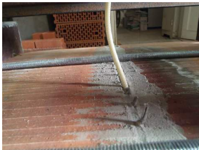
Фото 42. Стержень полимерного анкера после приложения нагрузки.
