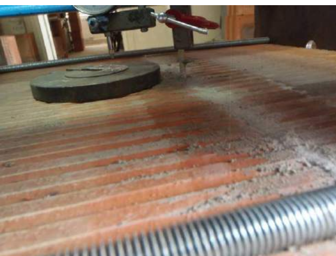
Фото 5. Индикатор фиксирует подвижки и перемещения полимерного анкера из образца при испытании на прочность при растяжении.
