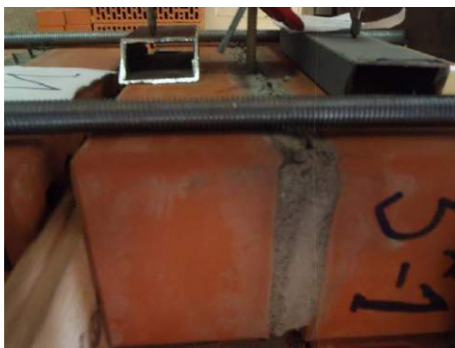
Фото 54. Образец-двойка лицевого кирпича 0,7 НФ Евро со швом, армированным базальтовой сеткой 12 мм.
