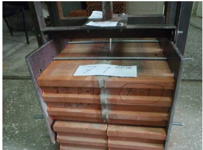
Фото 30. Стенд 2 для испытания композитных гибких связей на прочность при сжатии.
