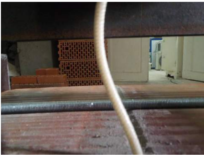
Фото 27. Стержень полимерного анкера после приложения нагрузки (сжатия).
