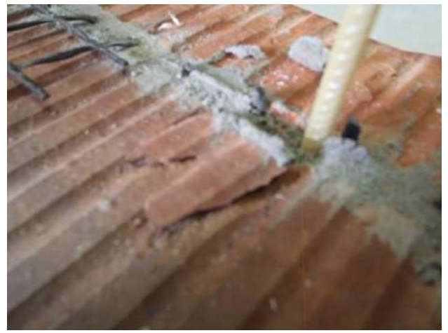
Фото 50. То же (см. ф. 49), другой ракурс. При испытании анкера произошел скол фрагмента керамического камня.
