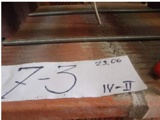
Фото 37. Образец-двойка из керамического камня Роготах-200 со швом, армированным базальтовой сеткой 12 мм.
