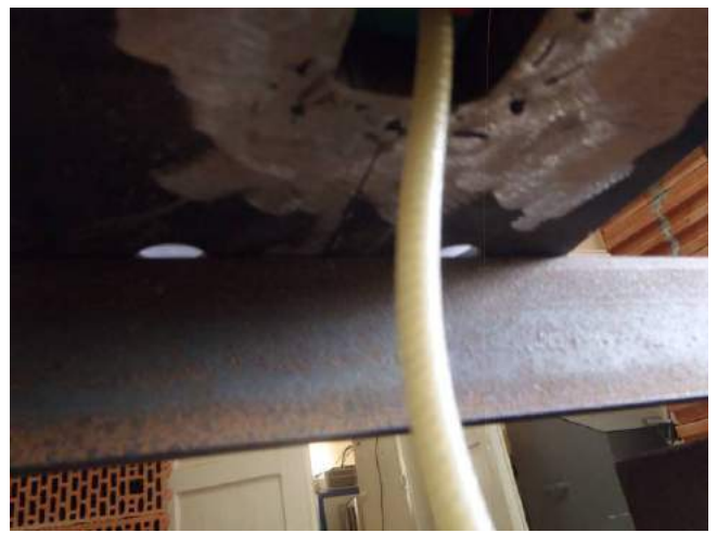
Фото 8. Стержень полимерного анкера после приложения нагрузки.
