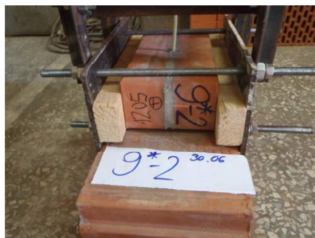
Фото 39. Образец-двойка кирпича лицевого 0,7 НФ Евро с укороченной заделкой анкера.
