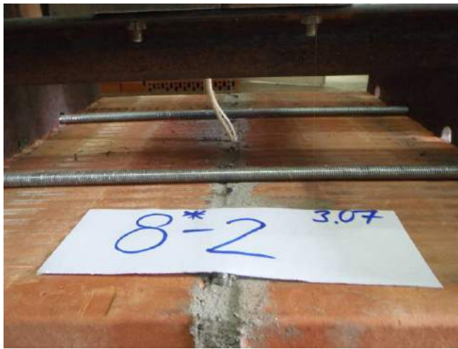
Фото 61. Испытание образца №2 серии 8* (образец-двойка керамического камня Rogotax-200 с укороченной заделкой стержня в шве, армированном стальной сеткой 14-16 мм). Разрушение стержня под действием нагрузки.
