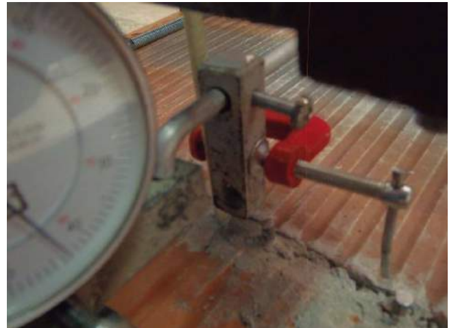
Фото 60. Образец-двойка керамического камня Рогатах-200 со швом, армированным стальной сеткой.
