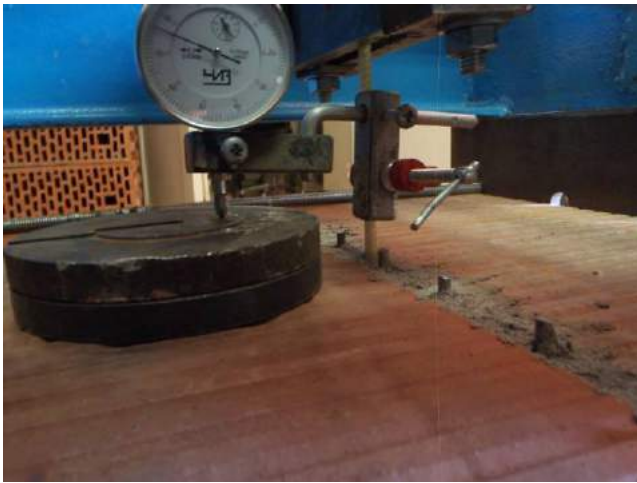
Фото 55. Фиксация перемещений полимерного анкера.
