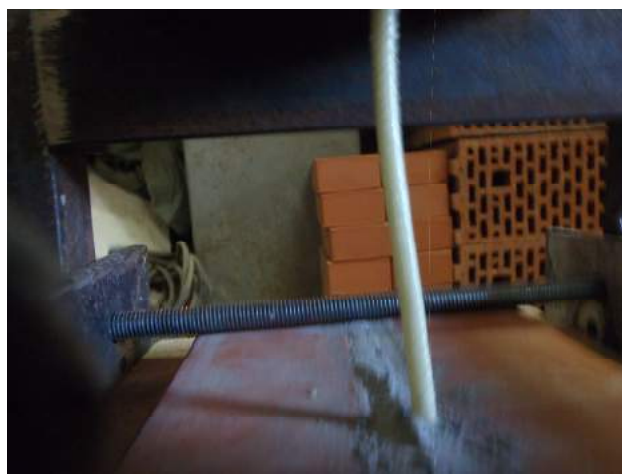
Фото 44. Положение анкера после сжатия в растворе шва под нагрузкой.
