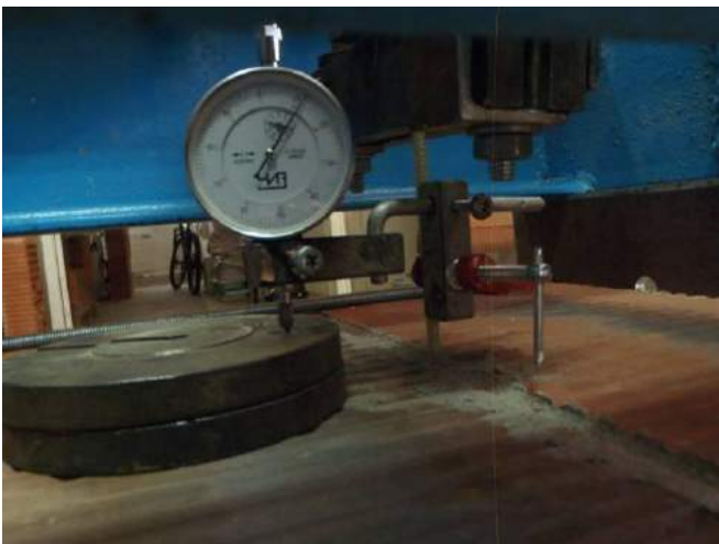
Фото 15. Индикатор показывает перемещения при испытании анкера из образца-двойки при нагружении.
