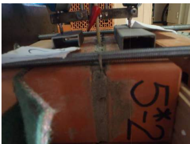
Фото 57. Образец-двойка кирпича лицевого со швом, армированным базальтовой сеткой 12 мм.
