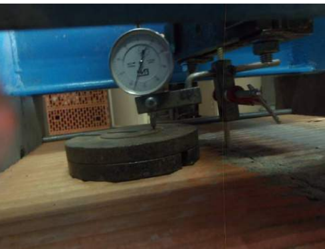
Фото 29. Индикатор фиксирует подвижки и перемещения испытуемого анкера.
