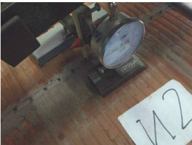
Фото 71. Образец-двойка из керамического камня Рогатах-200 со швом, армированным базальтовой сеткой 12 мм.
