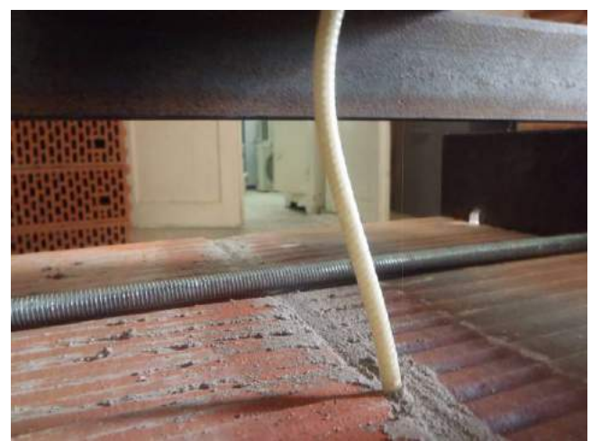
Фото 23. Стержень полимерного анкера после приложения нагрузки.
