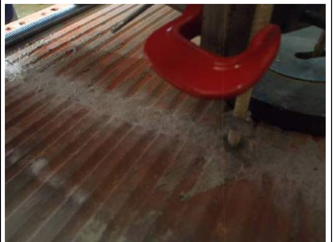
Фото 6. Критерием предельного перемещения анкера при вырыве из образца является величина, не превышающая 5 мм.
