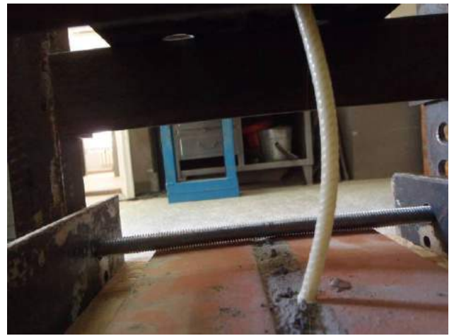
Фото 32. Стержень полимерного анкера после приложения нагрузки.
