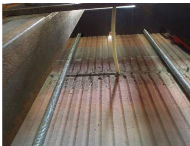
Фото 40. Положение анкера после сжатия в шве под действием нагрузки.
