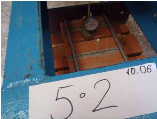
Фото 31. Образец-двойка кирпича лицевого 0,7 НФ Евро со швом, армированным базальтовой сеткой 12 мм .
