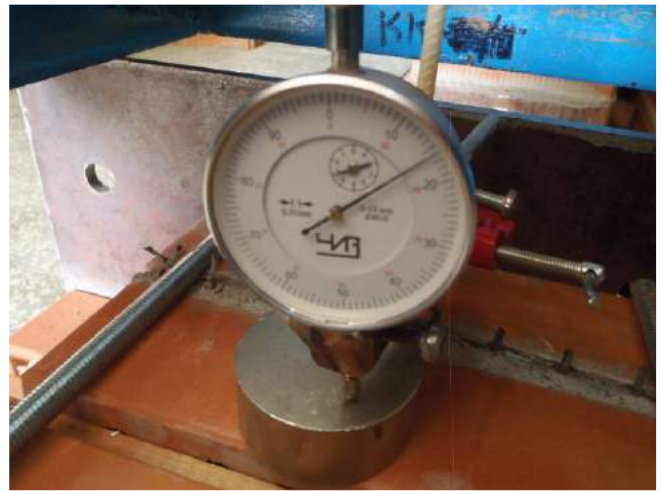
Фото 32. Индикатор часового типа для контроля перемещений при загрузке испытываемого образца.
