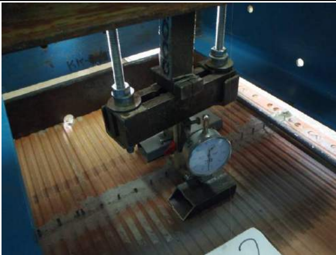
Фото 75. Вид анкера с крепежным приспособлением для индикатора (регистрации перемещений).
