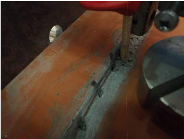
Фото 33. Стержень полимерного анкера после приложения нагрузки.
