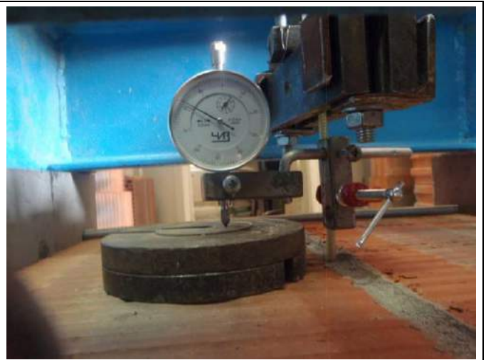
Фото 20. Фиксация перемещений полимерного анкера.
