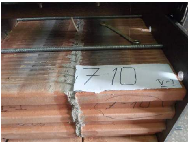
Фото 45. Испытание образца №10 серии 7 (образец-двойка керамического камня Роготех-200 со швом, армированным базальтовой сеткой 12 мм).
