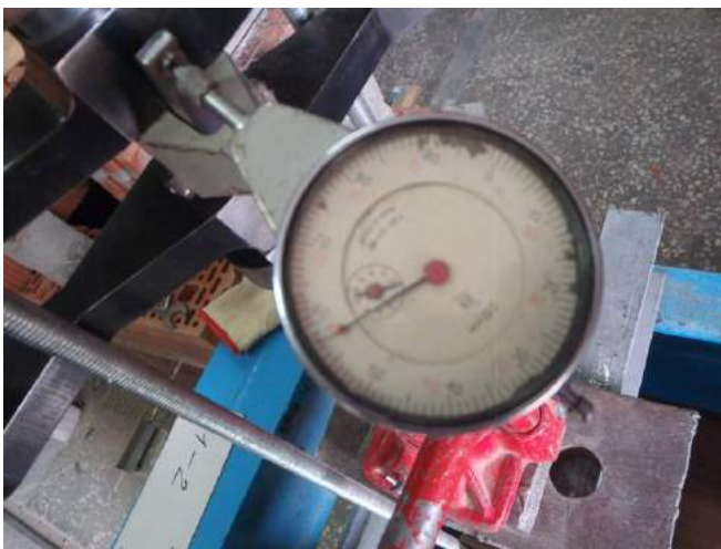
Фото 9. Величина нагрузки анкера фиксируется механическим динамометром сжатия ДОСМ 3-5.
