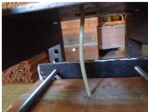
Фото 20. Положение анкера после сжатия. Видно выкрашивание частиц раствора из шва при действии нагрузки.
