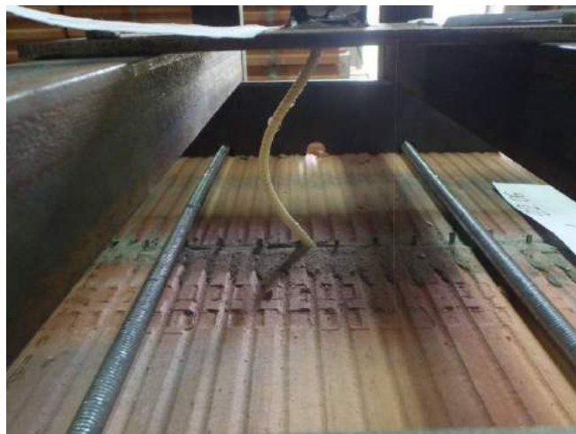
Фото 33. Стержень полимерного анкера после приложения нагрузки.
