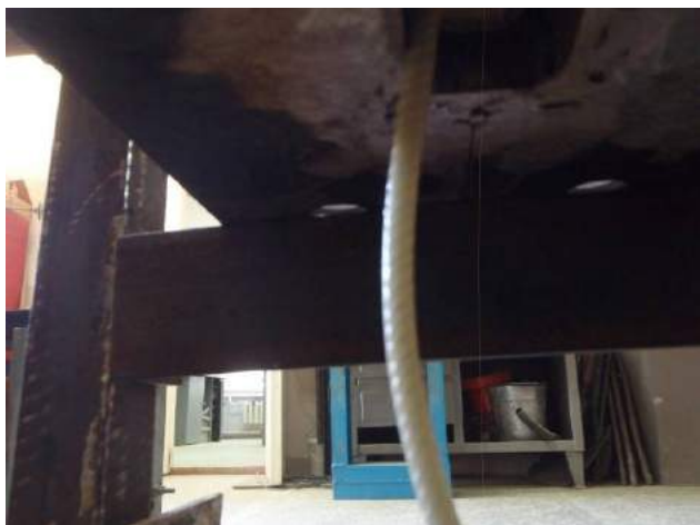
Фото 19. Стержень полимерного анкера после приложения нагрузки.
