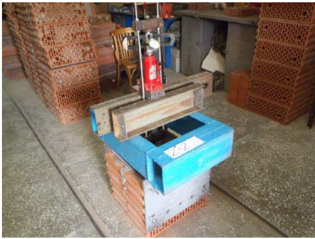
Фото 73. Общий вид стенда. Испытание 2 серии 2*. Укороченная заделка анкера в растворе шва образца.
