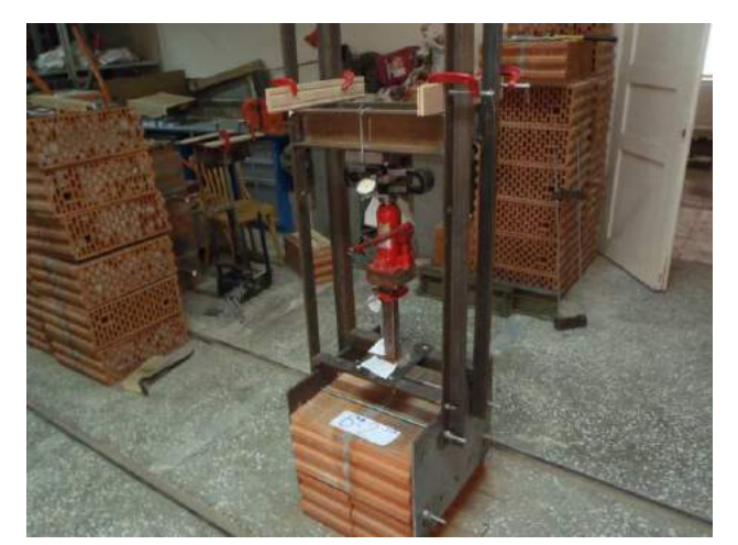
Фото 54. Стенд №2 для испытания композитных гибких связей на прочность при сжатии.
