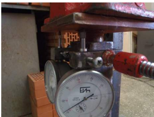
Фото 18. Индикаторы часового типа для контроля перемещений при загрузении испытываемых стержней образцов-двоек.
