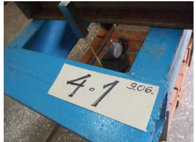
Фото 2. Стенд 1 для испытания композитных гибких связей на прочность при растяжении. Образцы кладки – кирпич «Евро» 0.7 НФ.
