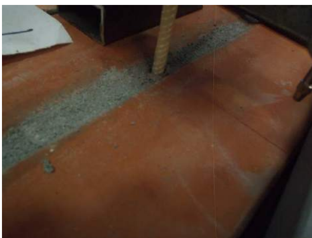
Фото 51. Положение анкера после испытания образца. Видно растрескивание кирпича в месте заделки анкера в шве под действием нагрузки.
