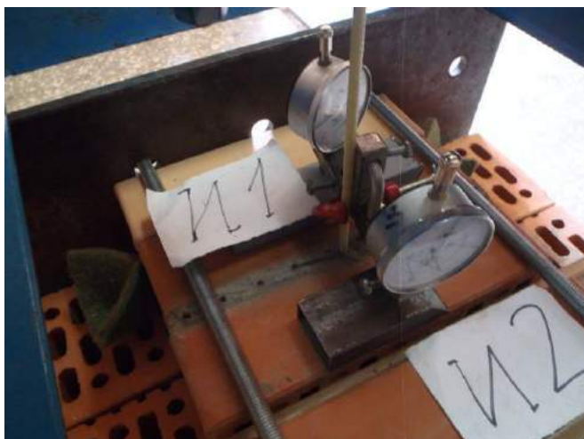
Фото 53. Индикатор фиксирует перемещения полимерного анкера из шва образца при испытании прочности при растяжении.
