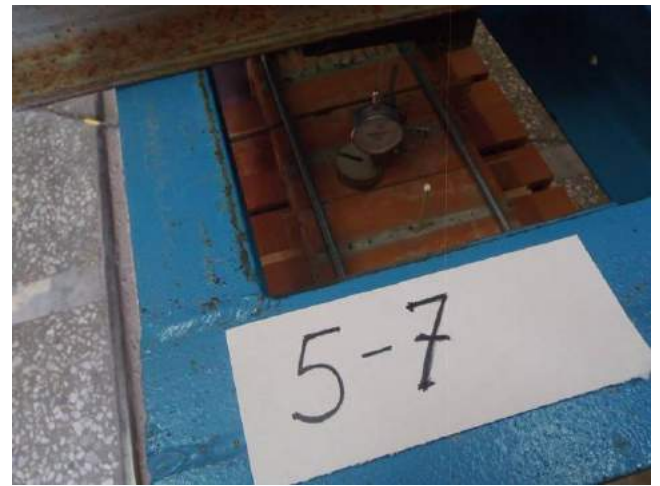
Фото 34. Испытание образца №7 серии 5 кирпича лицевого 0,7 НФ Евро на вырыв.
