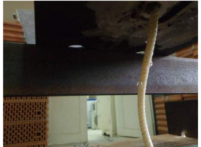
Фото 32. Стержень полимерного анкера после приложения нагрузки (сжатия). На стержне видны обрывы навивки при деформации стержня.
