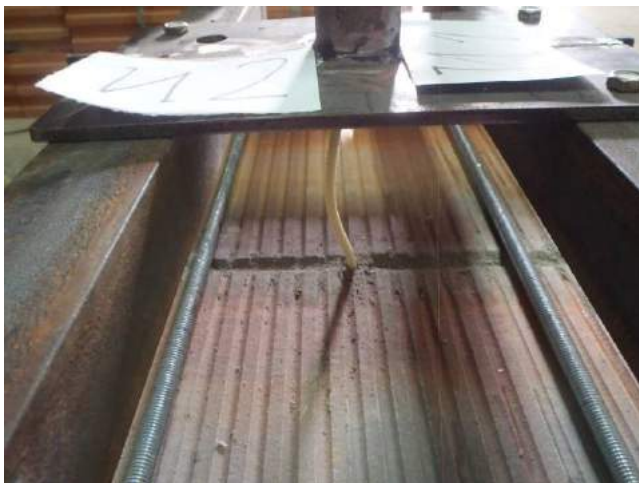
Фото 29. Положение анкера после сжатия в образце. Видно выкрашивание частиц раствора из шва при применении нагрузки.
