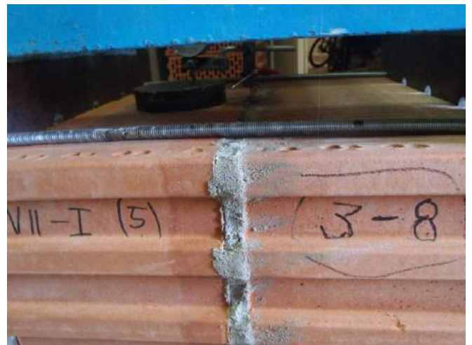
Фото 54. Образец-двойка из керамического камня Роготах-200 с базальтовой сеткой в растворе шва.
