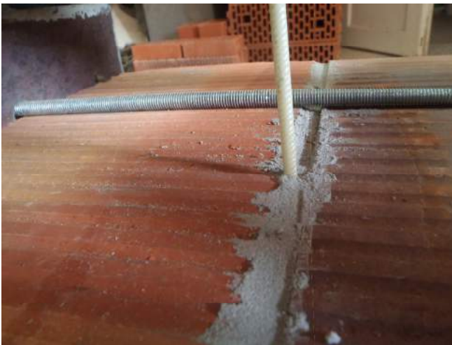
Фото 15. Образец-двойка керамического камня Роготах-200 со стандартным раствором швом 10 мм.
