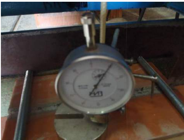
Фото 41. Индикатор часового типа для контроля перемещений при загрузении элементов испытываемых образцов.
