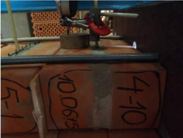
Фото 25. Образец-двойка кирпича лицевого 0,7 НФ Евро со стандартным раствором швом 10 мм.
