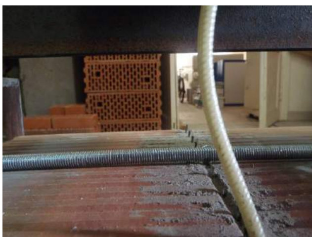
Фото 39. Критерием предельного перемещения анкера при сжатии в образце является величина, превышающая 5 мм или прогрессирующие деформации образца.
