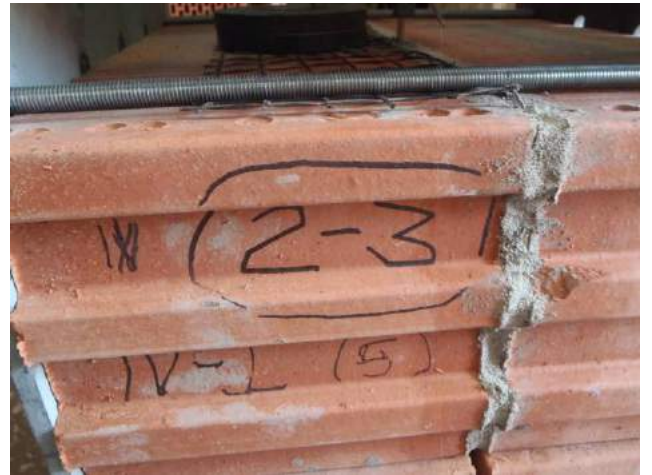
Фото 38. Образец-двойка из керамического камня Роготак-200 с базальтовой сеткой в растворе шва.
