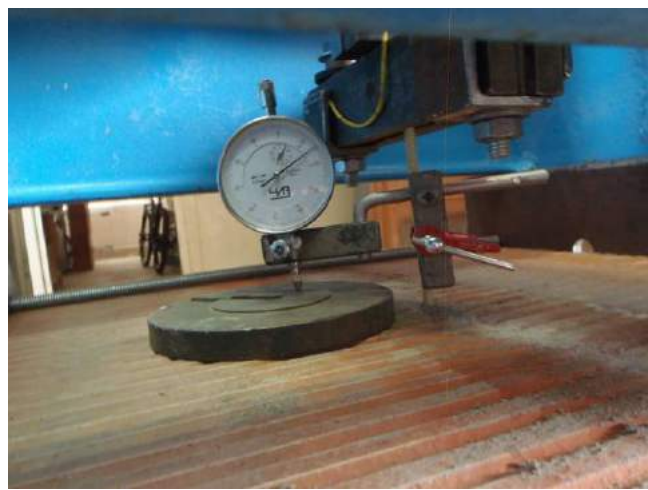
Фото 3. Индикатор часового типа для контроля перемещений при загрузке элементов испытываемых образцов.
