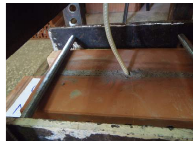
Фото 42. Анкер после испытания. Видно выкрашивание раствора из шва образца.
