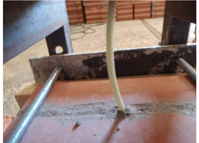
Фото 8. Анкер после испытания. Виден вырыв раствора из шва образца.
