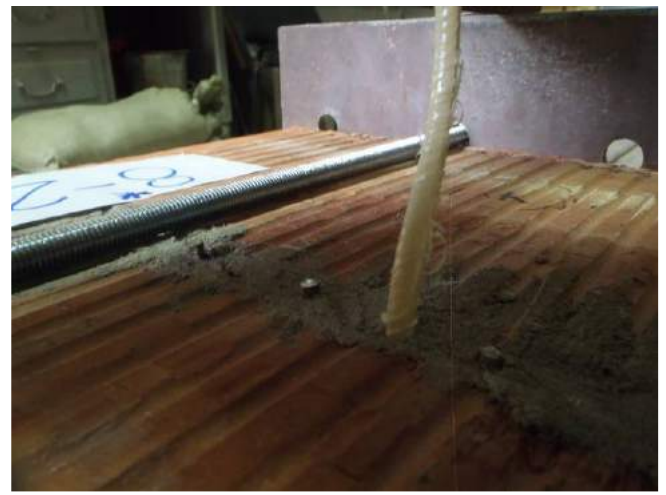
Фото 62. Положение анкера после сжатия в растворе шва под нагрузкой. Виден обрыв стекловолоконного шнура полимерного стержня.
