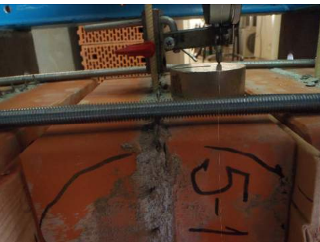
Фото 29. Вид анкера с присоединенным крепежом для индикатора для регистрации перемещений.
