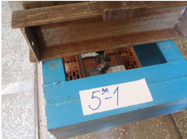
Фото 52. Испытание образца №1 серии 5* (дополнительные образцы с укороченной длиной анкеровки).
