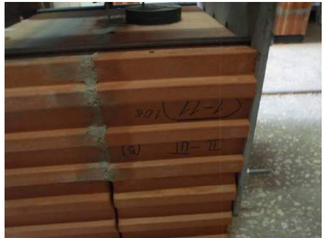
Фото 28. Образец-двойка керамического камня Рогатах-200 со стандартным растворным швом 10 мм.
