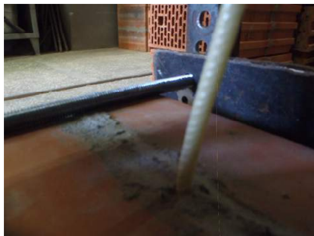
Фото 46. Анкер после испытания. Видно выкрашивание раствора из шва образца.
