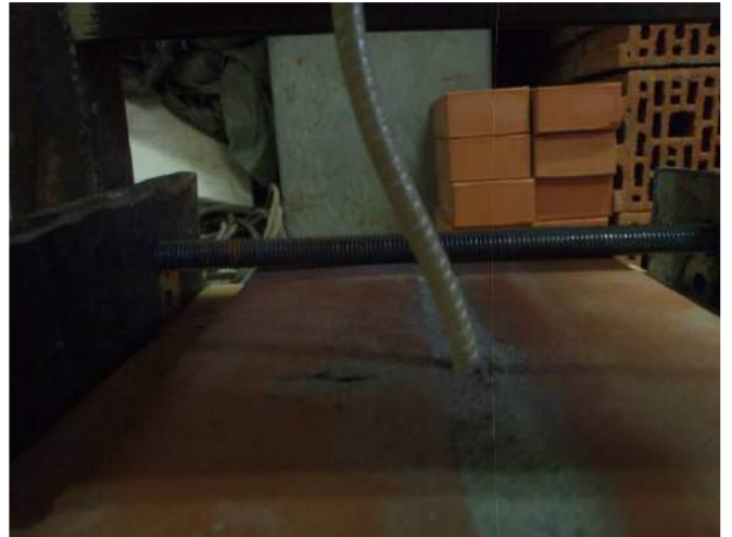
Фото 2. Образец-двойка кирпича лицевого 0,7 НФ Евро со стандартным раствором швом 10 мм.
