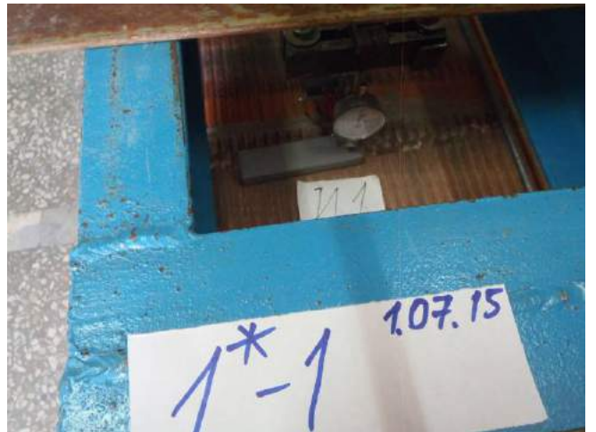
Фото 64. Испытание 1 серии 1* (нормальный шов с укороченной зоной анкерки – 52,5 мм).
