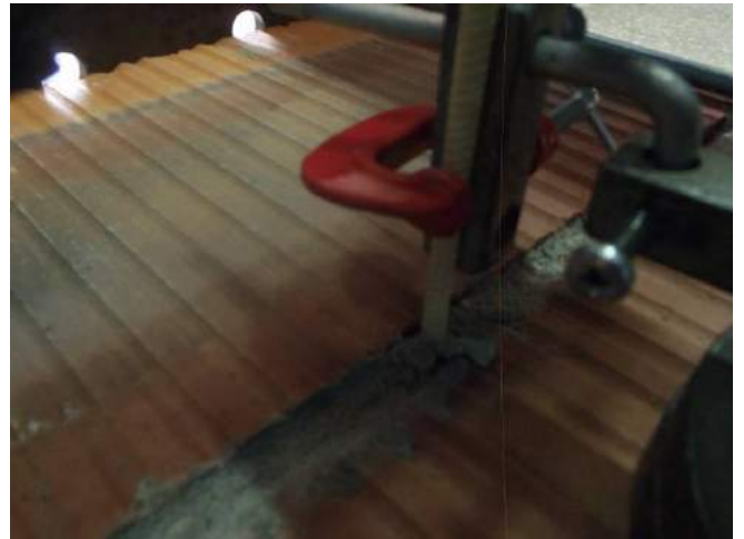
Фото 26. Анкер после испытания. Виден вырыв раствора из шва образца.
