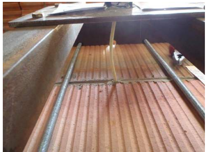
Фото 16. Производится ступенчатое нагружение очередного образца (сжатие).
