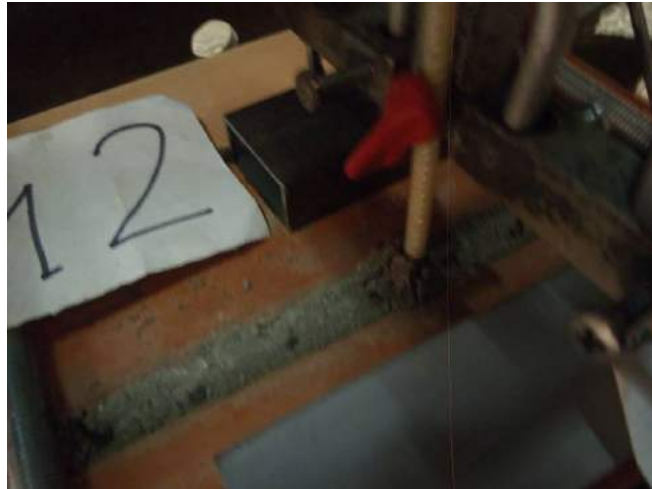
Фото 58. Положение анкера после испытания образца. Видно выкрашивание частиц раствора из шва при растяжении под нагрузкой.
