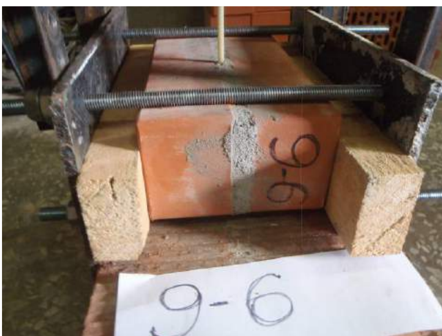
Фото 9. Образец-двойка кирпича лицевого 0,7 НФ Евро со стандартным растворным швом 10 мм.
