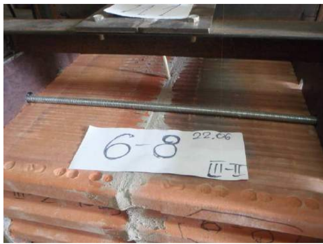
Фото 21. Образец-двойка керамического камня Роготех-200 со стандартным раствором швом 10 мм.
