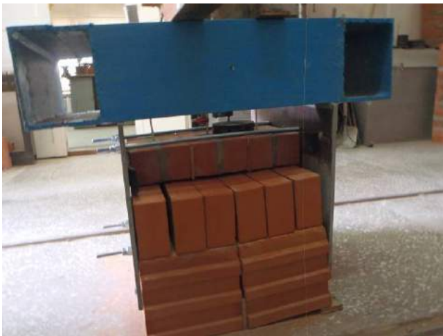
Фото 3. Образец-двойка кирпича лицевого 0.7 НФ «Евро» со стандартным раствором швом 10 мм
