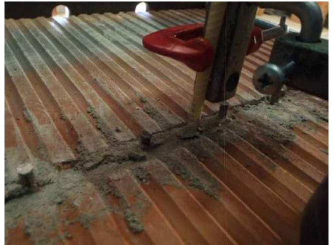
Фото 62. Анкер после испытания. Виден вырыв раствора из шва образца.
