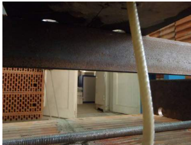
Фото 56. Стержень полимерного анкера после приложения нагрузки.
