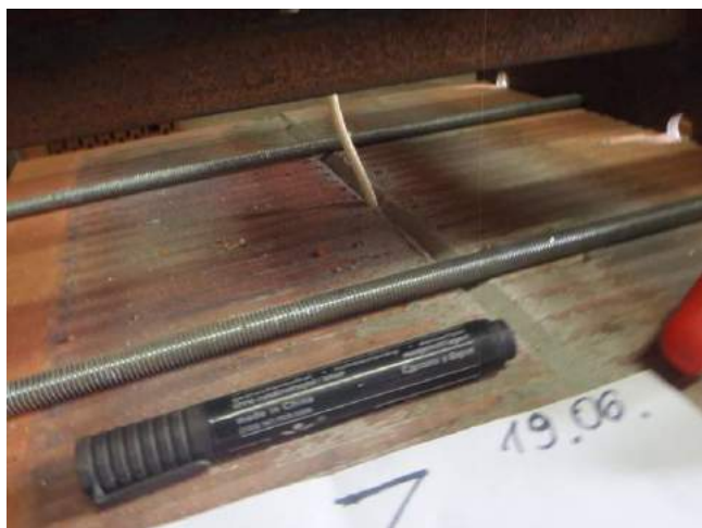
Фото 11. Образец-двойка керамического камня Роготах-200 со стандартным раствором швом 10 мм.
