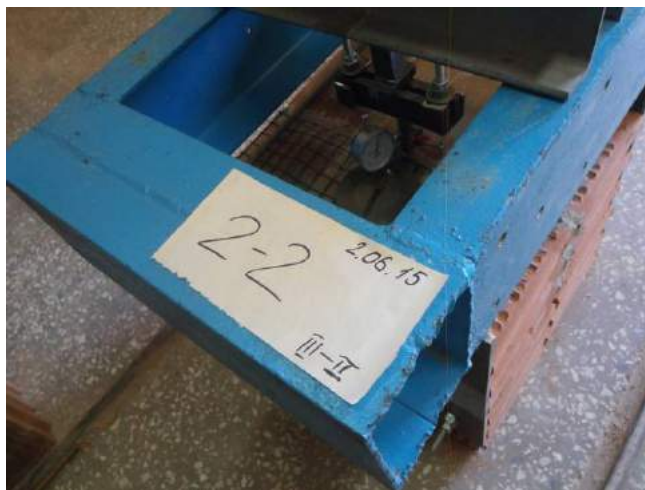
Фото 34. Испытание 2 серии 2. Образец-двойка из керамического камня Rogotax-200 с базальтовой сеткой в растворе шва.
