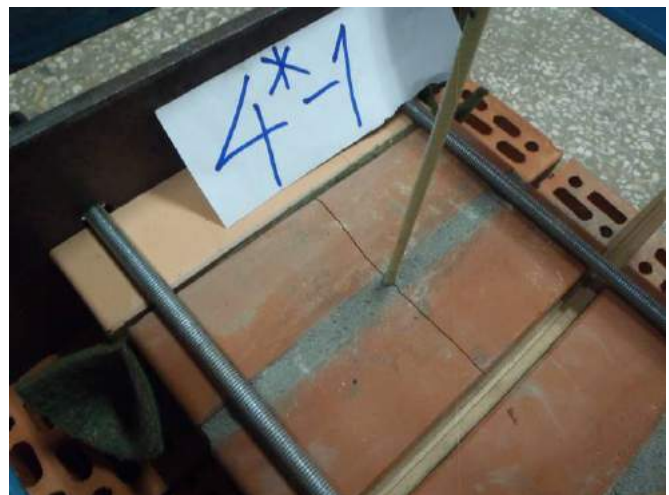
Фото 48. То же (см. ф. 47), растрескивание кирпича в месте заделки анкера в шве под действием нагрузки.
