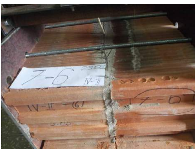
Фото 41. Образец-двойка из керамического камня Роготах-200 со швом, армированным базальтовой сеткой 12 мм.
