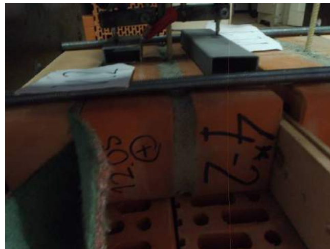
Фото 50. Укороченная заделка анкера в растворе шва образца-двойки.
