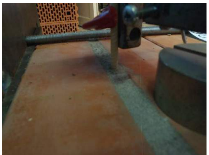
Фото 12. Вид анкера с крепежом для индикатора для измерений перемещений.
