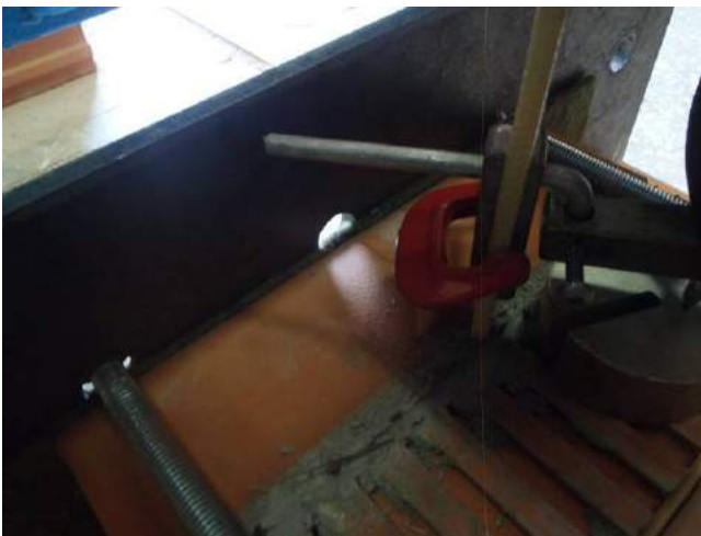
Фото 39. Критерием предельного перемещения анкера при вырыве из образца является величина, превышающая 5 мм или не стабилизирующиеся деформации связи.
