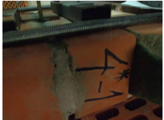
Фото 46. Образец-двойка кирпича лицевого 0,7 НФ Евро со стандартным растворным швом 10 мм.
