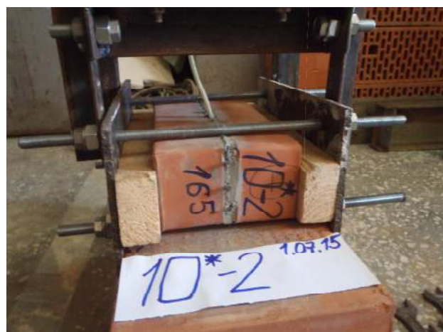
Фото 47. Испытание образца №2 серии 10* кирпича лицевого 0,7 НФ Евро с укороченной заделкой анкера в шве, армированном базальтовой сеткой 12 мм.
