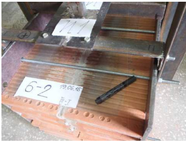
Фото 7. Испытание образца №2 серии 6. Шов не армирован.
