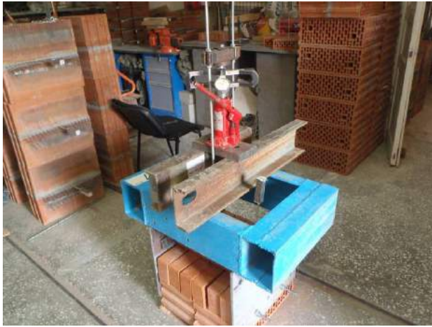
Фото 1. Место проведения работ – испытательная строительная лаборатория, помещение с нормальными температурно-влажностными условиями. Общий вид стенда испытаний на вытягивание анкерной связи.
