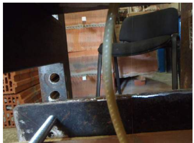
Фото 36. Положение анкера после сжатия в растворе шва под нагрузкой.
