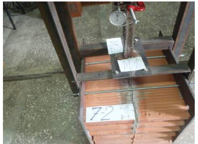
Фото 34. Производится ступенчатое нагружение очередного образца с фиксацией по шкале индикатора.
