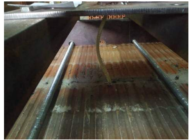
Фото 52. Стержень полимерного анкера после приложения нагрузки.
