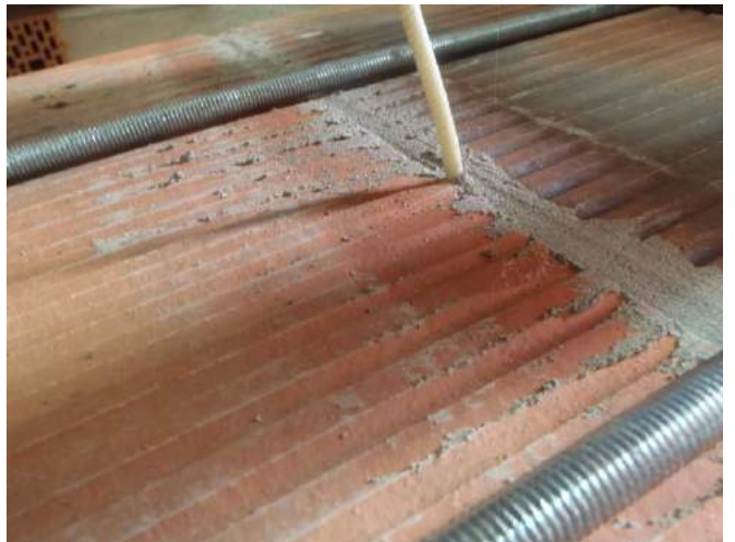
Фото 22. Производится ступенчатое нагружение очередного образца (сжатие).
