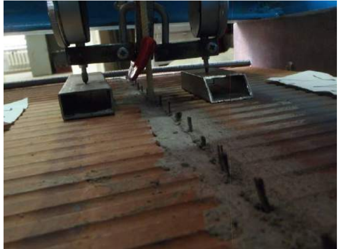
Фото 74. Образец-двойка из керамического камня Роготах-200 со швом, армированным базальтовой сеткой 12 мм.
