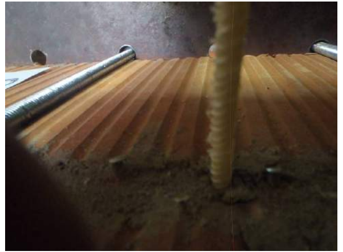
Фото 50. Анкер после испытания. Видим вырыв раствора из шва образца и обрыв наливки полимерного анкера.
