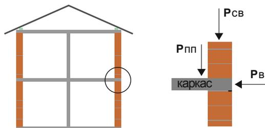
**Pсв** – нагрузка от собственного веса стены, **Pпп** – нагрузка от перекрытий и покрытий, **Pв** – ветровая нагрузка.
